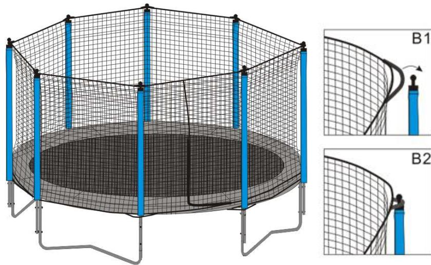
Разложите защитную сетку (8) на прыжковом полотне. Найдите проход в сетке и выровняйте сетку относительно места, куда Вы хотите войти и выйти из батута. Установите сетку на верхние стойки с помощью предварительно сшитой петли. (См. фотографии).
