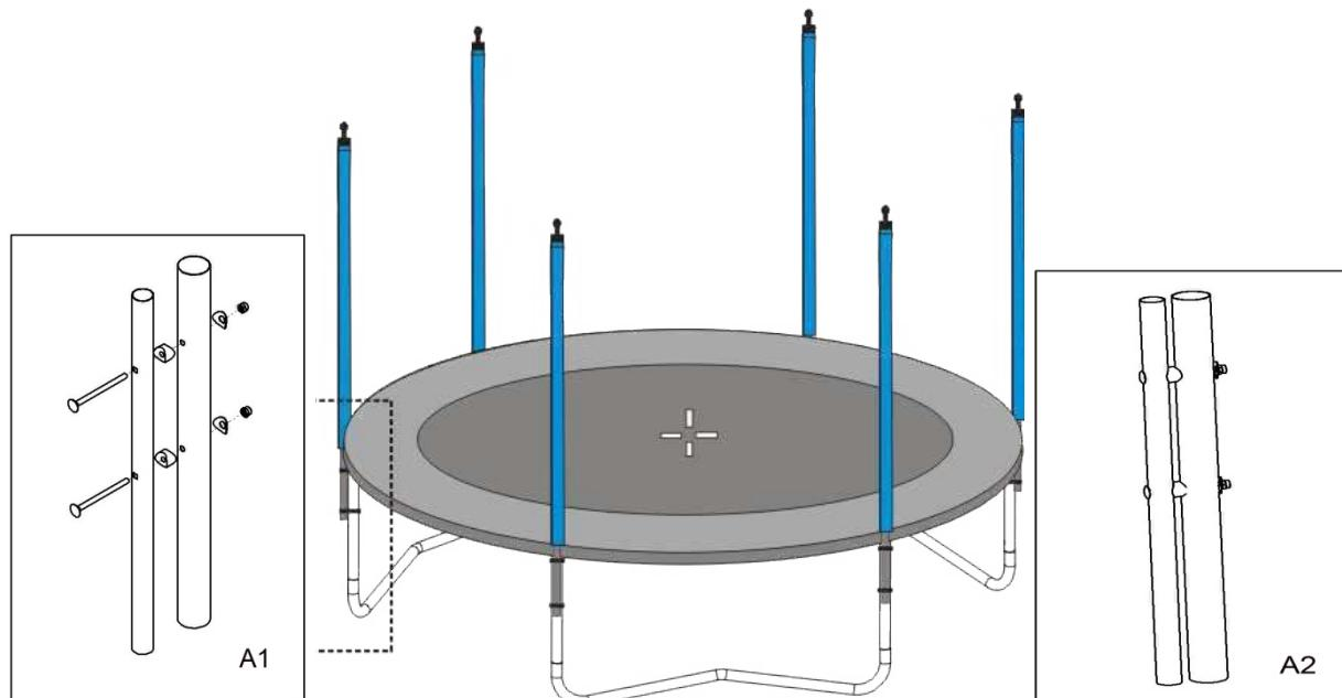
Закрепите верхние стойки на батуте, используя винты, втулки, шайбы и гайки, как показано на рисунке.
